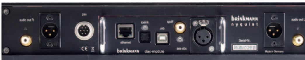
Der inzwischen selten anzutreffende digitalsymmetrische AES/EBU-Eingang harmoniert mit symmetrischen 1100-Ohm-Quellen. Wie immer, benötigt man zum Betrieb eines Computers über den USB-Eingang Treiber für Windows, die auf einem mitgelieferten Stick bereitliegen.
