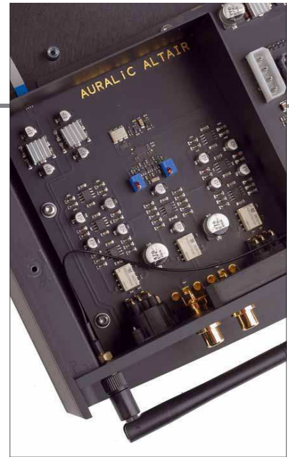
Der interne Wandler ist zusammen mit der Ausgangsstufe baulich vom Rest des Gerätes getrennt
